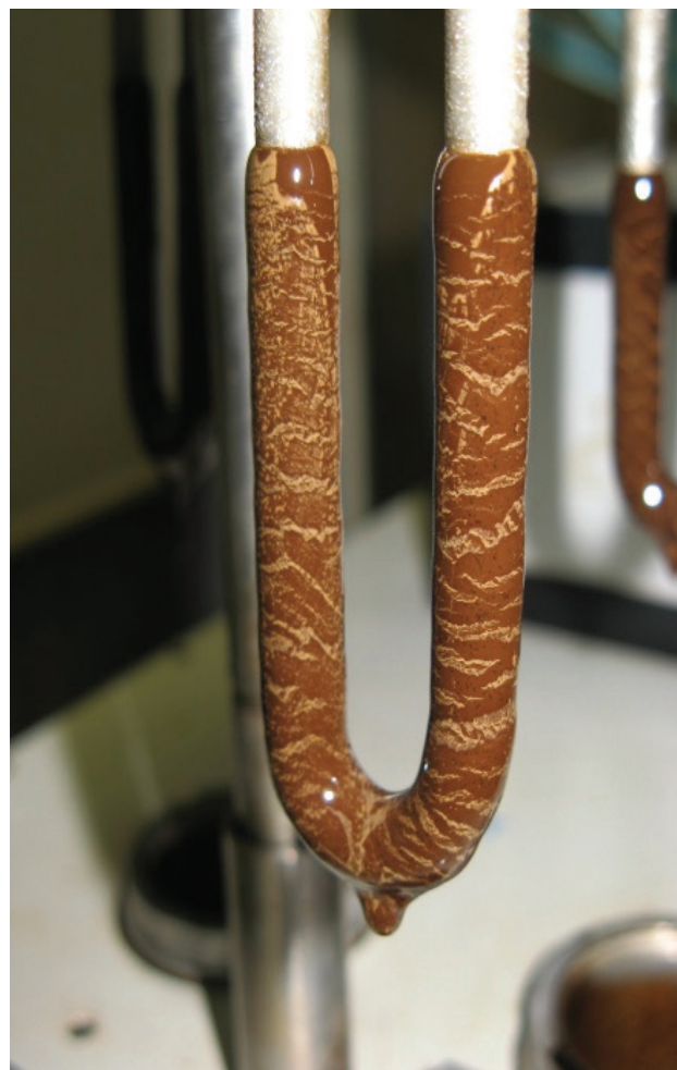
Рисунок 2 – АСПО, выделенные из пробы нефти девонского горизонта (скважина 13808) методом холодного стержня
