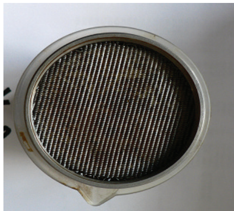
Рисунок 4 – Взаимодействие 15%-й ингибированной HCl с добавкой 4% об. Нефтенола К марки «НК-20» с нефтью (нет осадков АСПО)
