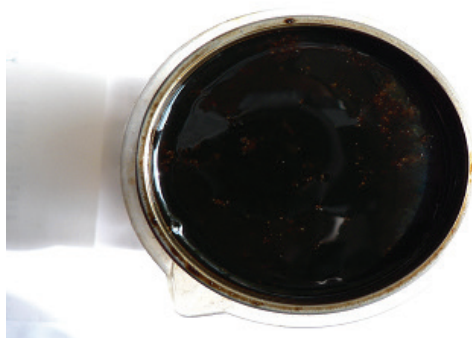
Рисунок 3 – Осадок АСПО после взаимодействия 15%-й ингибированной HCl (без ПАВ) с нефтью
