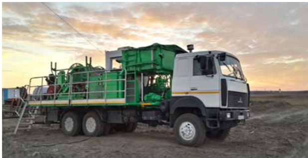
Рисунок 1 – Установка для струйного вскрытия пласта СВП1
