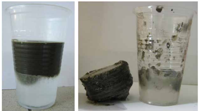
а) б) Рисунок 1 – Эксперимент по возможности формирования цементного камня на контакте геля ВНП и состава БТР: а – исходное состояние (состав БТР сверху, гель ВНП снизу), б – цементный камень, образовавшийся на контакте составов
