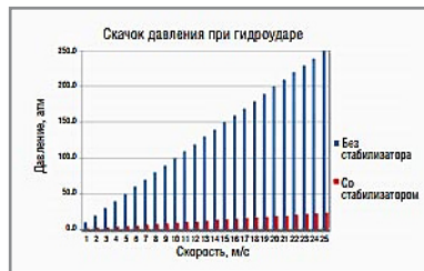
Рисунок 5 – Эффективность срабатывания стабилизатора давления при различных скоростях потока в масле
