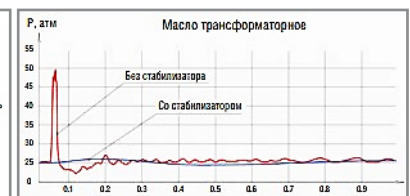
Рисунок 8 – Снижение давления при гидроударе без стабилизатора и со стабилизатором
