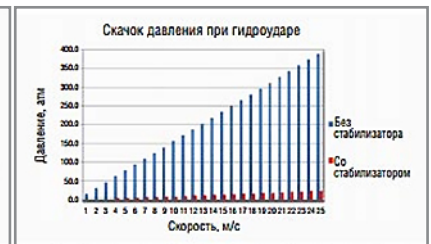
Рисунок 6 – Эффективность срабатывания стабилизатора давления при различных скоростях потока в воде
