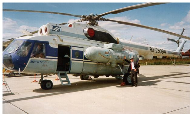
Рисунок 2 – ГАЗОЛЕТ – вертолет на газовом топливе
